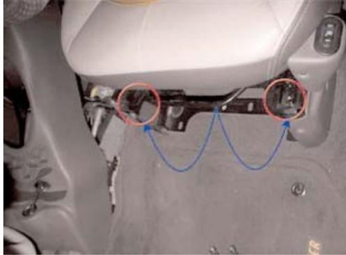
Reculer à présent le siège et refaire la même opération sur la traverse avant. Retirer le siège et le reculer jusqu'à toucher la banquette arrière, voire même le sortir de l'habitacle. Fixation identique sur les deux sièges. Tirer fortement le frein à main et soulever la console basse.
