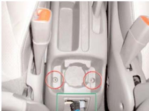
Toujours avec le tournevis cruciforme, ôter les vis situées de part et d'autre du porte-gobelets arrière (repères rouges). Insérer le tournevis plat entre la console et le support des boutons des lève-vitres arrière et faire délicatement levier (repère vert). Débrancher le connecteur
