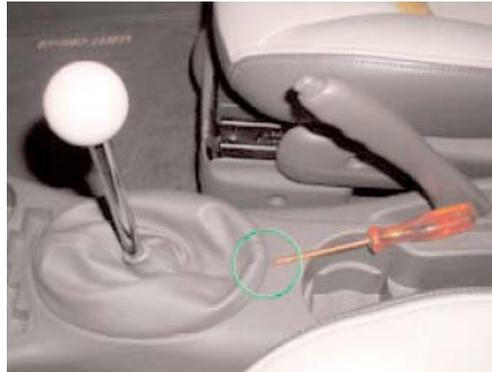
Insérer le tournevis plat, délicatement entre le soufflet et la console. Faire doucement levier de façon à déclipser le soufflet
