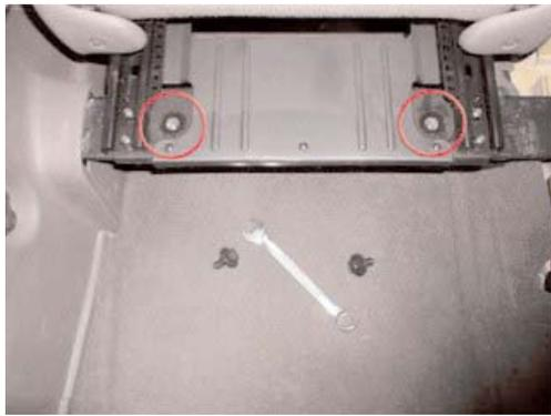
Avancer le siège conducteur au maximum, et defaire les 2 boulons de fixation de la traverse arrière.
