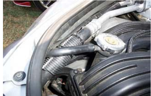
Après la pose d'une protection
