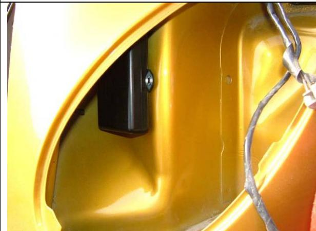
Etape 10 : fixation du boîtier de contrôle.
